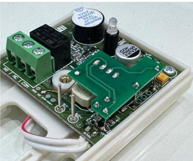
Wenn die Platine aufgesetzt und verlötet ist, die überstehenden Drähte möglichst knapp über der Platine abzwicken, ansonsten passt der Gehäusedeckel (speziell am runden Rand) nicht mehr sauber drauf.
